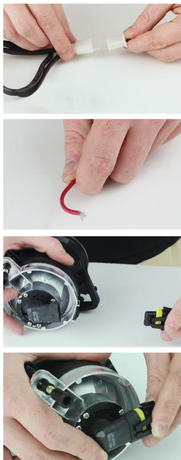
Conecte estos dos cables para terminar la instalación y activar el interruptor de botón.
